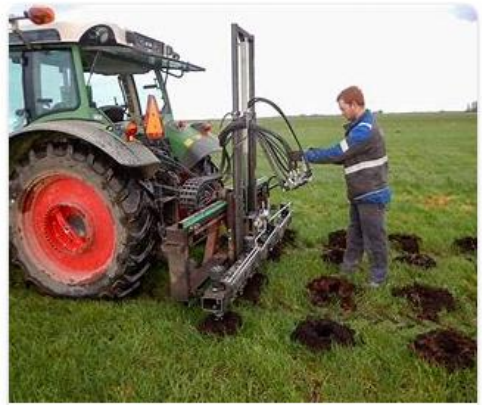
Gaten boren in veen om bodem te verbeteren | Veeteelt.nl
