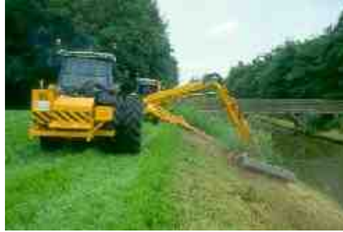
Maaien oevers en taluds
